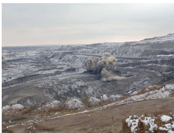
Рис. 2.7. Электронное инициирование зарядов при ведении буровзрывных работ
